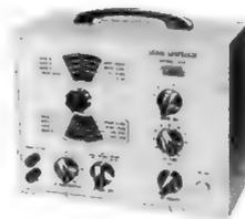
Universal-Meßsender in Luxusausführung, 7 Frequenzbereiche von 150 kHz bis 435 MHz  $\pm 1,5\%$ , beleuchtete Skala, regelbarer 400 Hz-NF-Ausgang, 220 V
