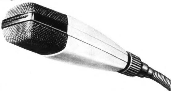
Übertragungsbereich 30 – 17000 Hz. Dabei läßt das Meßprotokoll, das jedem MD 421 beiliegt, nur Abweichungen bis  $\pm 2,5$  dB von der Sollkurve zwischen 40 und 16000 Hz zu. Die Rückwärtsdämpfung hat weitgehend bei allen Frequenzen oberhalb 250 Hz den günstigen Wert von 16 dB.
