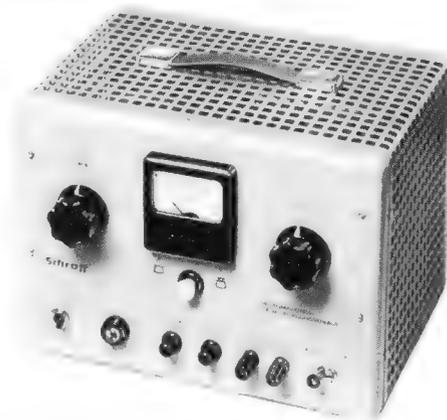
6/12 V regelbar, 10 A, Innenwiderstand 0,5 Ω, Brummspannung 10 mV
